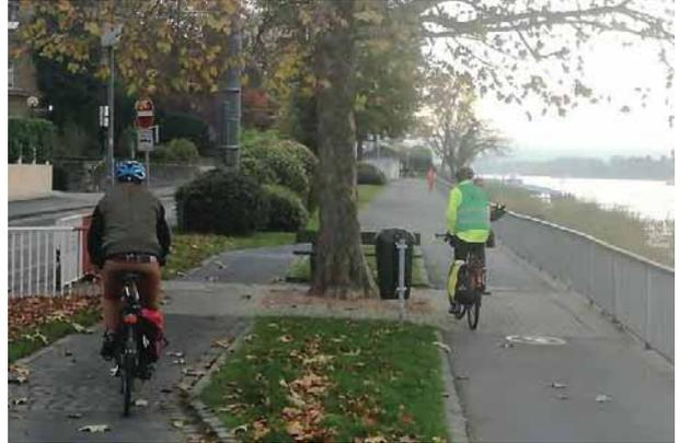
Foto 26: Es muss vermieden werden, dass Fußgängerquerungen des Radwegs ausgerechnet dort sind, wo ein Baum und eine Bank den Raum verengen. Die Fußgängerquerungen sind an geeigneter Stelle so zu gestalten, dass ein sicheres Überqueren des Radwegs möglich ist (gute Sichtbeziehungen, reduzierte Radgeschwindigkeit, Möglichkeit eines Zebrastreifens prüfen).
