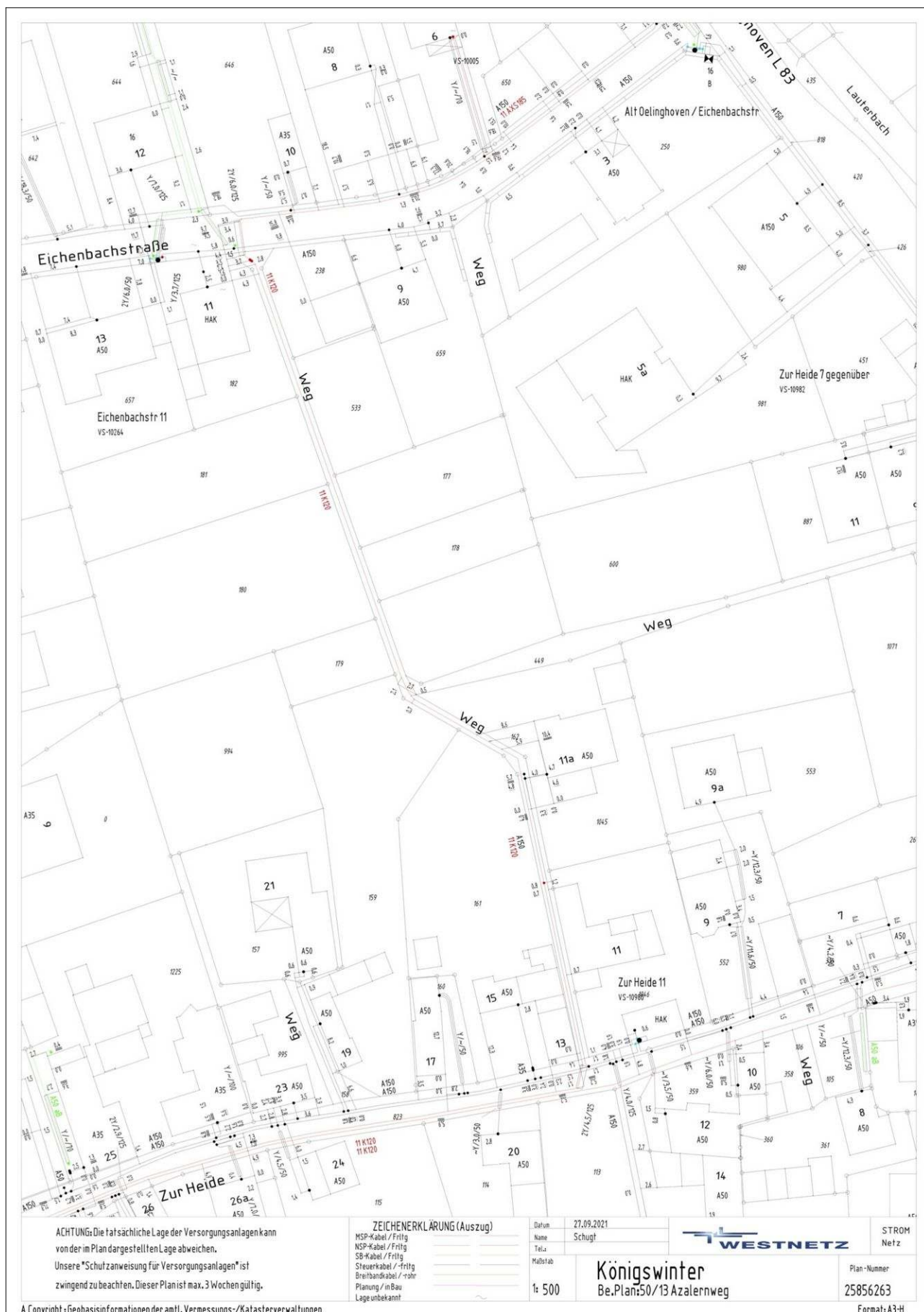
Abb. 9: Vorhandene Leitungen der Westnetz GmbH
